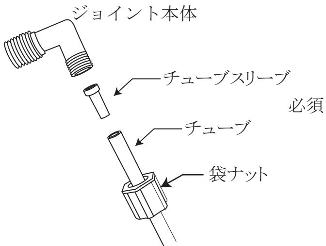
袋ナットをレンチ等で反時計回りに回せば簡単に外せますが、チューブの先にはチューブスリーブが入っていますので無くさないようにして下さい。
